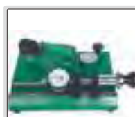
controllare l'accuratezza degli indicatori a quadrante (intervallo 0-25mm)
