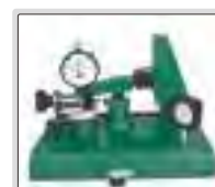
verificare l'effetto della forza laterale sulla precisione degli indicatori a quadrante (è necessario un blocco semitondo)
