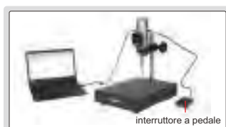
dati trasmessi a Excel senza software; premere brevemente l'interruttore a pedale per trasmettere i dati, premere a lungo per azzerarli
