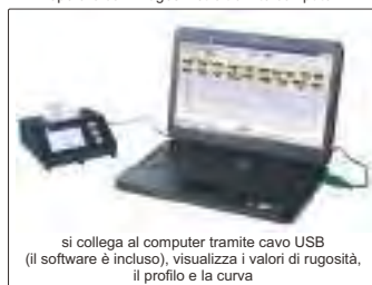
operare con il rugosimetro tramite computer
