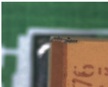
Osservazione al microscopio normale (superiore) Con una differenza di altezza, è possibile mettere a fuoco solo il piano superiore o inferiore.
