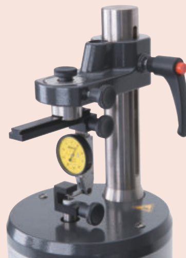
Calibrazione del comparatore leva con accessori opzionali
