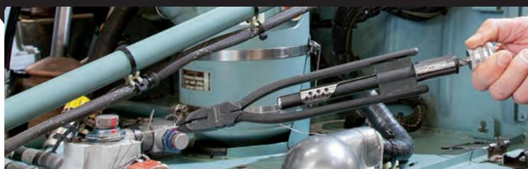
**Consentono di torcere rapidamente i fili di frenaggio di sicurezza, garantendo il blocco degli assemblaggi sottoposti a vibrazioni.**
