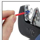
Posizionamento del capocorda e del filo dopo crimpatura.
