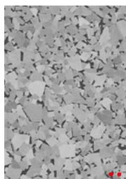
Substrato in metallo duro cementato di durezza maggiore rispetto all'RT9020; ideale per una più lunga vita utensile nelle applicazioni ad elevata stabilità.
