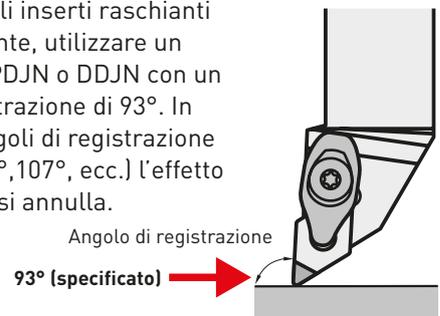
Mostra una grande efficienza del tratto raschiante durante la lavorazione della superficie frontale e del diametro esterno sia nella lavorazione destrorsa che in quella sinistrorsa.
