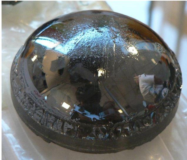
**Figura N°4-** *Cristallo singolo di carburo di silicio prodotto da uno dei laboratori Minattec.*
