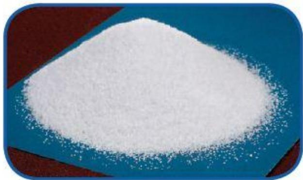
**Figura N°3** - Cristalli di ossido d'alluminio bianco (99%  $Al_2O_3$ ) (CGW)
