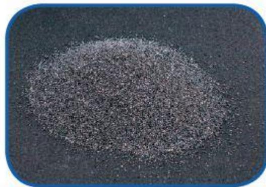
**Figura N°5** - *Cristalli di carburo di silicio nero (durezza 9,5 della scala Mohs) (CGW)*
